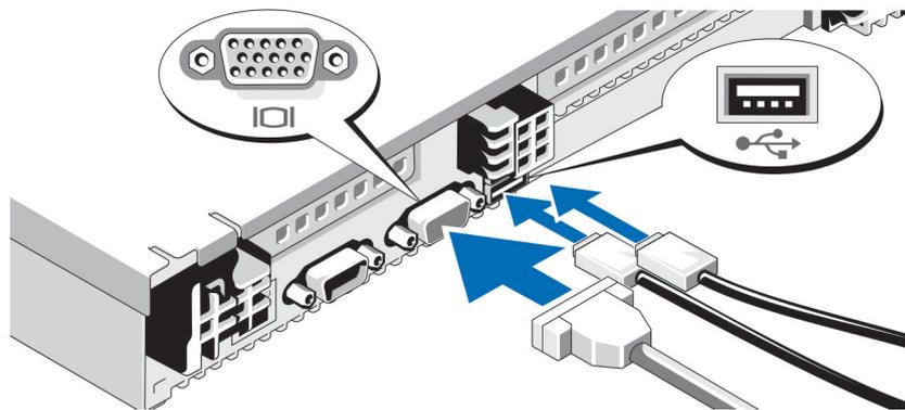
Abbildung 2. Anschließen von Tastatur, Maus und Bildschirm
